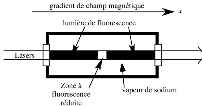
FIG. 2 – Le principe de l'expérience mettant en évidence les *résonances noires*.
