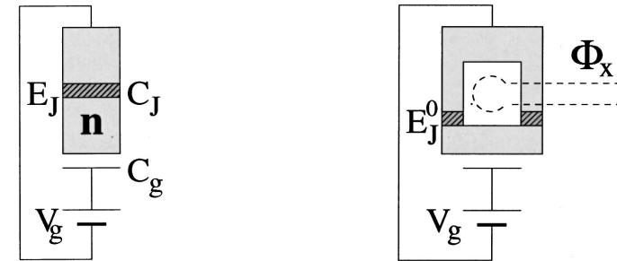
FIGURE VI.6. Gauche : boîte à paires de Cooper simple. Droite : boîte à paires de Cooper à deux jonctions, permettant de disposer d'un E_J(\Phi) ajustable. Figures extraites de MAKHLIN, SCHÖN et al. (2001).
